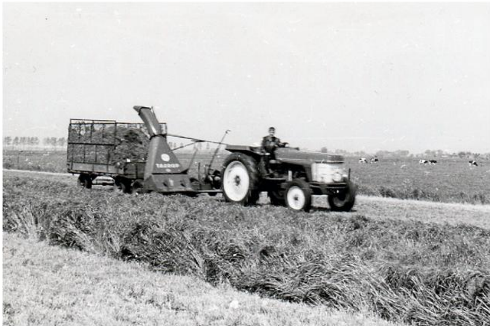
MAAIKNEUZEN "VAN STAM", WAS EEN METHODE DIE ALLEEN GESCHIKT WAS VOOR LANGER UITGEGROEID GRAS.
