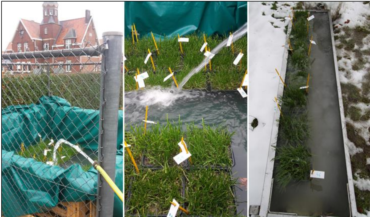
Figuur 2.2: Opstelling bij de overstrooming van de potproef. Links: groot bassin waarin alle niet-controlepotten geplaatst werden. Midden: tijdens het overgangsregime vóór de overstrooming werd het bassin tot aan de potranden gevuld. Rechts: het overgangsregime telkens na een overstrooming vond plaats in het klein bassin.
