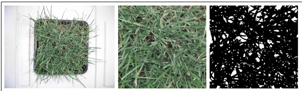
Figuur 2.3: Links: een initiële foto van een pot met Engels raigras, genomen vóór het instellen van de overstromingen (20 november). Midden: de foto nadat de randen van het statief en de pot zijn weggewerkt. Rechts: de foto na omzetting tot een binair beeld met behulp van Threshold Colour in ImageJ.
