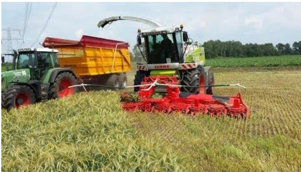
Figuur 6: hakselaar met rijonafhankelijke Kemperbek voor oogst hakselgraan (Trekkerweb, 2014)
