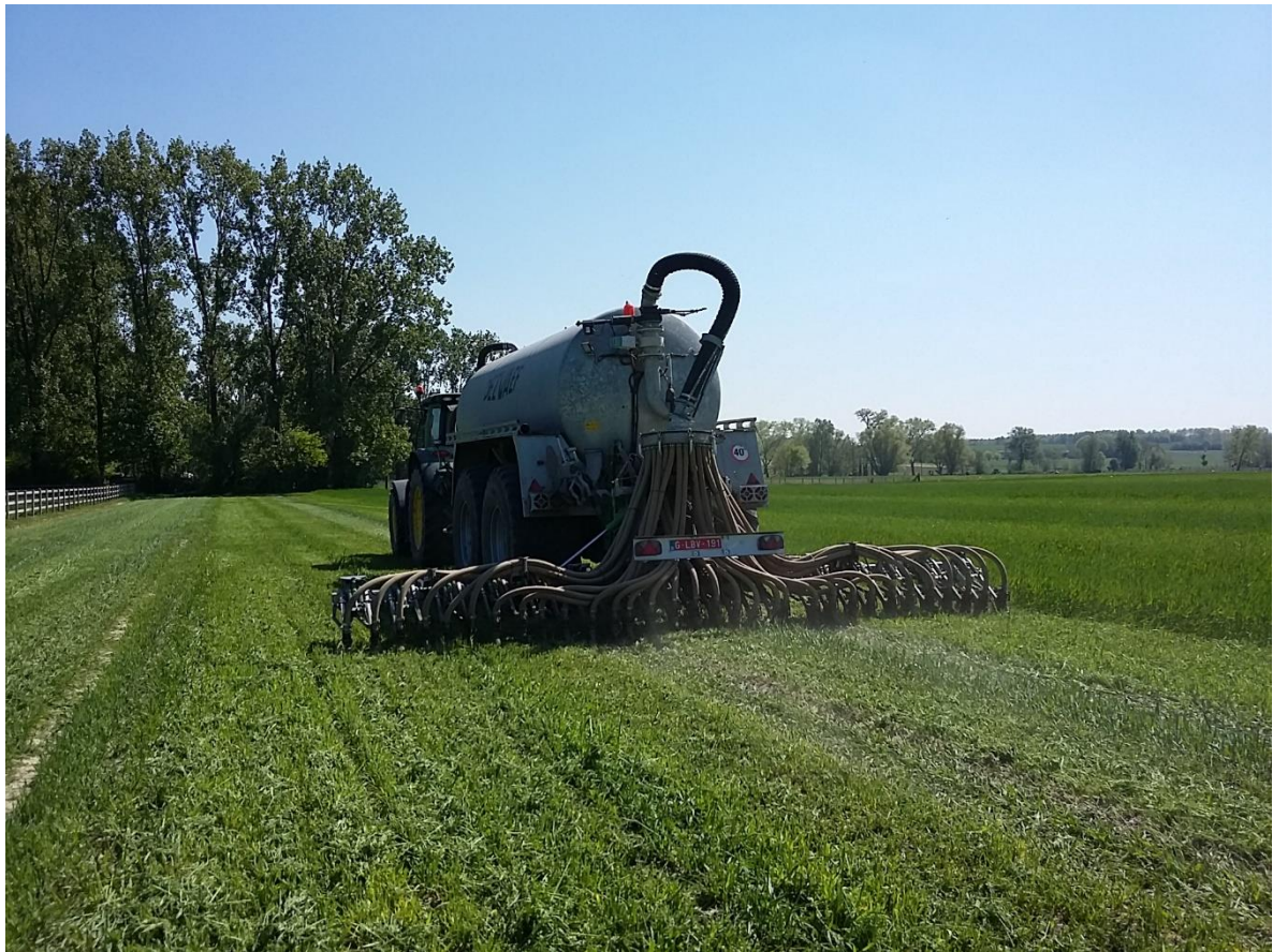
Figuur 14: graslandinjecteur met sleepvoeten aan het werk op (23/04/2020) bij toediening mengmest na een eerste maaisnede (Latré, 2020)
